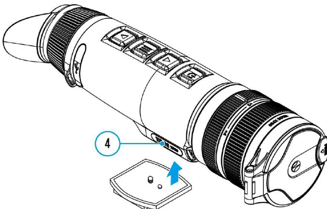
1. Vissez jusqu'à la butée la plaque de support du trépied dans le pas de vis(4).
