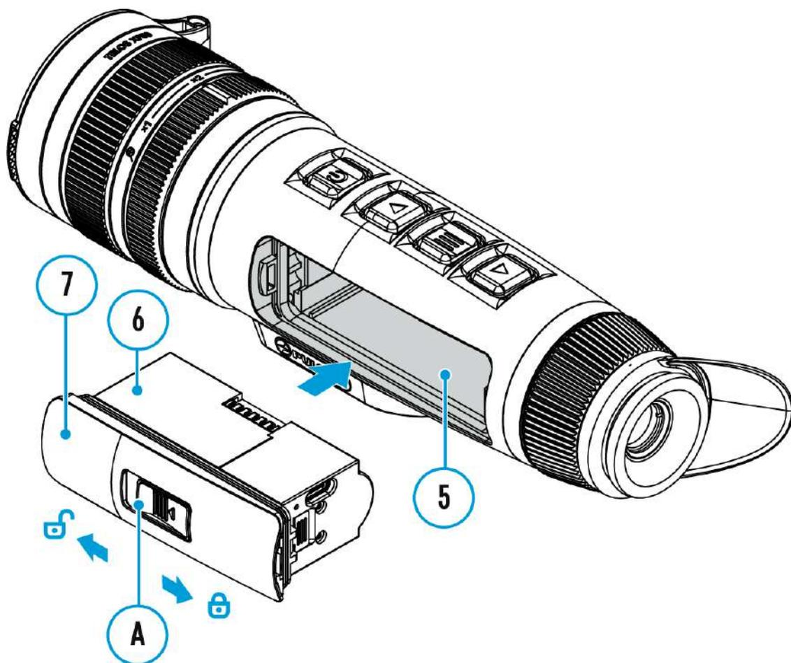
3. Pour retirer la batterie (6), faites glisser l'interrupteur (A) sur le couvercle (7) vers la gauche
