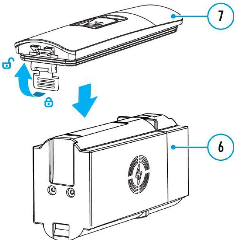
2. Insérez la batterie (6) dans son compartiment (5) jusqu'à entendre un clic. Les contacts de la batterie doivent être orientés vers le haut de l'appareil (voir schéma).
