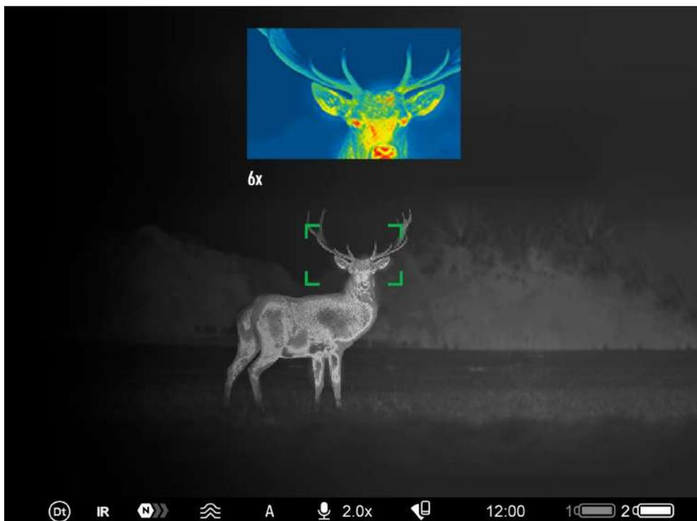
Dans le mode multispectral PiP, l'image d'un canal s'affiche dans la fenêtre principale, et l'image d'un second canal s'affiche dans la fenêtre PiP.
